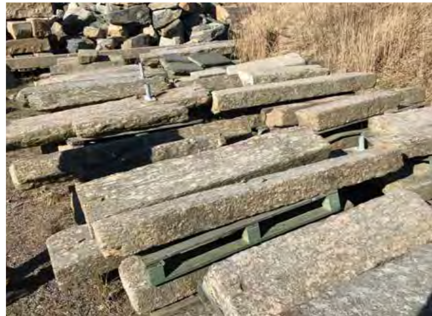
Begagnade kantstöd som ej följer dagens standard kan användas som friser, planteringskantstöd eller inslag i markbeläggning.
